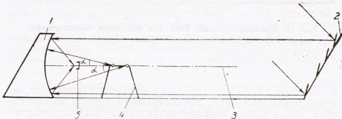
Рис. 12. Схема юстировки концентратора по методу нормалей:
